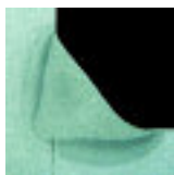
Proceso GMAW posición 2F en placa de acero al carbono de 8mm. de espesor utilizando mezcla Infra-Ferro D
